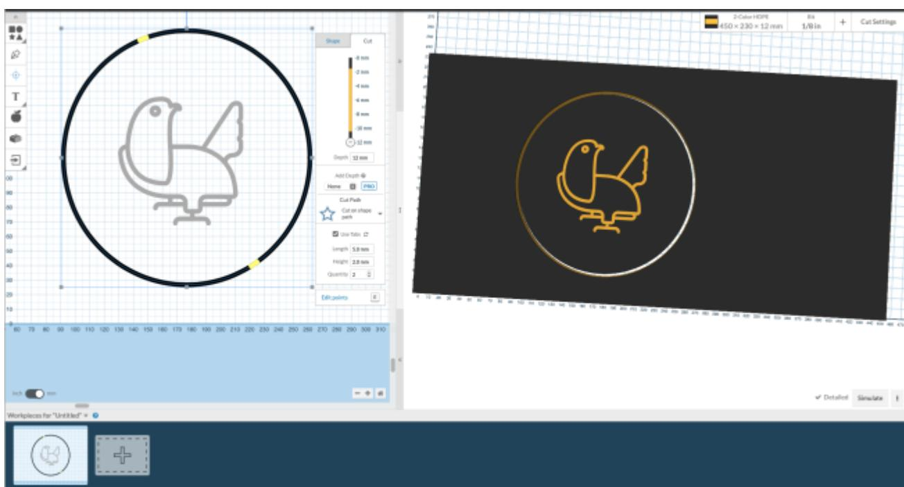
Easel ist eine browserbasierte [CAD/CAM](#)-Software zur Steuerung von CNC-Fräsen, wie beispielsweise eine [Xcarve](#)<sup>1)</sup>. Sie vereint Entwurf, Toolpath-Berechnung und Maschinensteuerung in einer integrierten Umgebung. Das System richtet sich sowohl an Einsteigerinnen als auch an fortgeschrittene Anwenderinnen, die Wert auf eine schnelle und übersichtliche Prozesskette von Design bis Fertigung legen.
