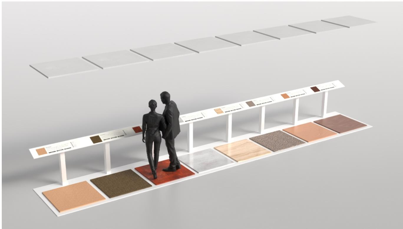
Bild oben: Konzept: 3D-Rendering des Materialpfads. Über den texturierten Kacheln befinden sich Richtlautsprecher.
