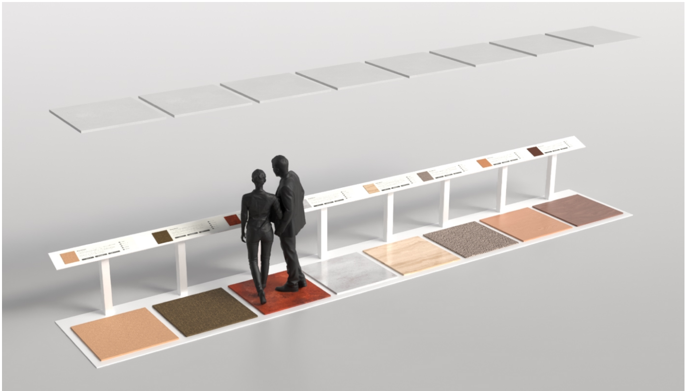
Bild oben: Konzept: 3D-Rendering des Materialpfads. Über den texturierten Kacheln befinden sich Richtlautsprecher. Das Projekt „Reactive Floor Panels“ entwickelt das Konzept eines begehbaren, reaktiven Materialpfads aus Kacheln, die unterschiedliche (natürliche) Bodenbeläge repräsentieren. Beim Betreten einer Kachel werden Besucher in eine immersive Soundumgebung geführt: ein Ambient-Sound läuft, und über ein Interface können zusätzlich thematische Audioinformationen zum jeweiligen Material ausgelöst werden. Ziel ist, Bodenbeläge als Teil des Raums erfahrbar zu machen und materialbezogene Eigenschaften wie Tast- und Laufgefühl sowie Umweltaspekte (z. B. Recyclingfähigkeit und Brennbarkeit) niedrigschwellig zu vermitteln. Die Interaktionslogik wird über Flussdiagramme beschrieben und in einer prototypischen JavaScript-Anwendung sowie einem Hardware-Prototyp mit Sensorik demonstriert.
