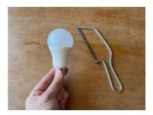
Als erstes wurden alle Teile der LED-Birne, die nicht am Gewinde befestigt waren, einschließlich der elektrischen
