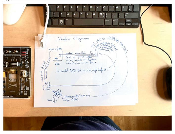
Obiges Datenfluss-Diagramm gibt einen Überblick, wie die verschiedenen Teile der Anwendung zusammenarbeiten, um die Steuerung des Servomotors über den runden Schieberegler in der Webanwendung zu ermöglichen.
